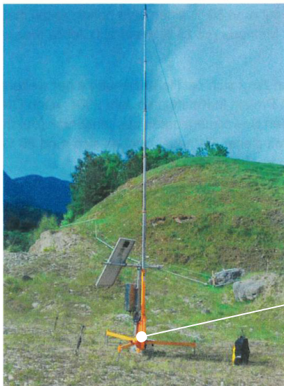
Abb.3: Die Messstelle an einem Hügel, der die Windrichtung verändert.
