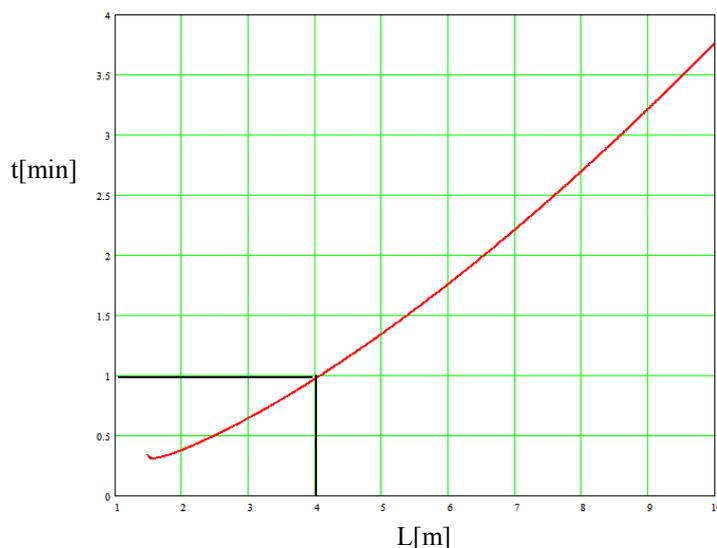
Abb.4: Löst man Gleichung (5) nach  $t$  auf, kann man die benötigte Zeit  $t$  als Funktion von  $L$  für ein bestimmtes  $y_{\max}$  berechnen. Für  $L=4\text{m}$  mit  $y_{\max}=1.5\text{m}$  benötigt man bereits eine Minute.
