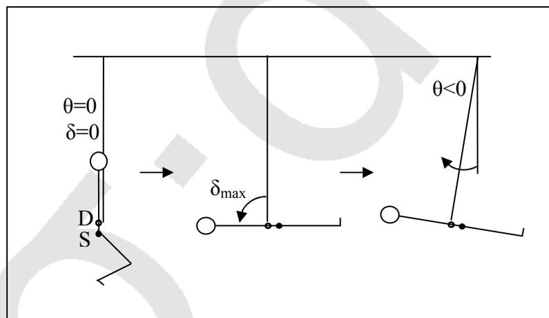
Abb.2: Drehimpulserhaltung. Aus der Anfangsposition  $\delta(0)=0$ ,  $\theta(0)=0$  wird durch das Rückwärtslehnen von K ein Drehimpuls erzeugt. Anfangs ist der Drehimpuls erhalten, d.h.  $(ML^2\dot{\theta} + J\dot{\delta}) = 0$ , deshalb bewegt sich das Pendel zunächst in die andere Drehrichtung.
