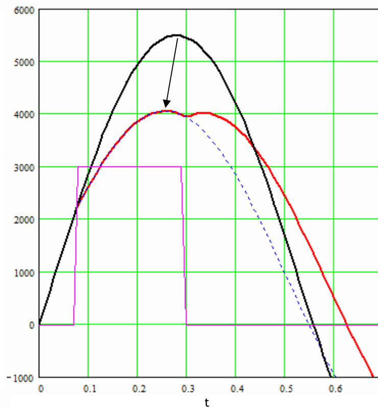
Abb.6-2: Die schwarze Kurve zeigt die Zeitabhängigkeit des Fangstoßes ohne Kontrolle ( u=0 ). Die rote Kurve ist der reduzierte Fangstoß für t_0=0.075 sec und t_e=0.3 sec mit u = 3 m/sec. Die Differenz zwischen der roten und der blau gestrichelten Kurve ist die zusätzliche Kraft wegen des Seilstops. Die Geschwindigkeit des Seildurchlaufs u beträgt 3000 mm/sec (magenta). ( \omega = 6.25 \text{ sec}^{-1} , v_0 = 9.185 \text{ m/sec} , s = 67.5 \text{ cm} (Gleichung (6.8)).
